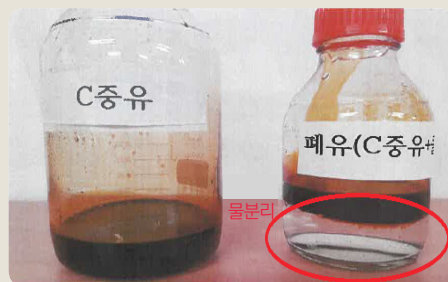
▲ 분리작업(물짜기) → 물과 기름의 비중차로 인해 시간이 경과하면서 자연스럽게 분리
