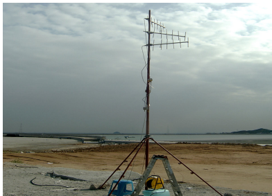
<그림 13> 수신기와 수신 안테나 설치 모습
