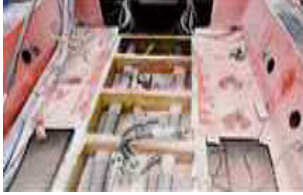
사고단정 내부구조는 다수의 격벽은 설치되어 있으나, 연료와 전기배선 연결부분 등의 격벽들은 밀폐되지 않은 상태
