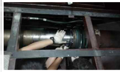
No.1 축계 기어커플링 (Hub 및 Adapter 부) 용접 보강
