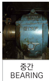
사진으로 본 AQUAMASTER CP PROPULSION UNIT 작동
