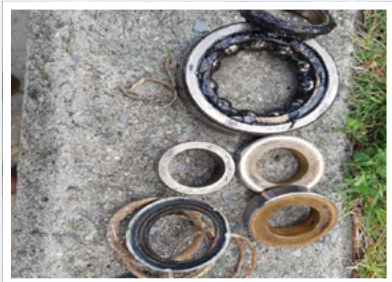
ROTARY SEAL 파손 및 베어링 소손 사진
