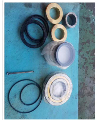
ROTARY SEAL 및 베어링 교환(신품)
